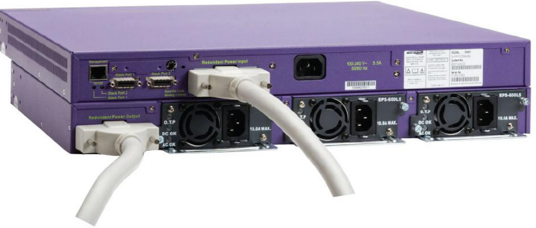
Корпус NXESPSU450T (вид сзади) с тремя установленными модулями NXESPSU450
